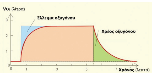
Εικόνα 4. Διάγραμμα πρόσληψης οξυγόνου ως προς το χρόνο σε πρωτόκολλο σταθερού έργου όπου απεικονίζονται το έλλειμμα και χρέος οξυγόνου. Όταν ευθιάζεται η καμπύλη πρόσληψης οξυγόνου επιτυγχάνεται σταθερή κατάσταση (steady-state). Ο χρόνος μέχρι να επιτευχθεί το steady-state καθώς και το έλλειμμα οξυγόνου χαρακτηρίζουν την κατάσταση του μυϊκού συστήματος και την ικανότητα για άσκηση.
